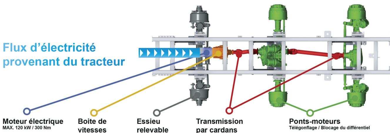
La technique E-Drive de JOSKIN est un système hybride s'articulant autour de plusieurs éléments-clés, avec en première position : le moteur. Véritable pièce maîtresse du système, ce moteur du fabricant SCHABMÜLLER transforme l'énergie électrique reçue en une puissance mécanique allant jusqu'à 120 kW et ce à un couple de 210 Nm (maximum 300 Nm). La boîte de transfert à embrayage est quant à elle fournie et conçue par DINTEC.
